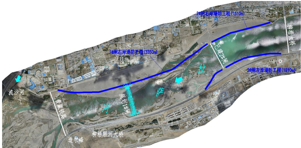
图 2.6-5 规划 1#闸右岸与与 2#闸左右岸堤防工程平面布置示意图
