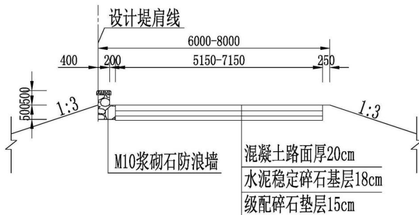
图 2.8-2 堤顶路面标准断面图
