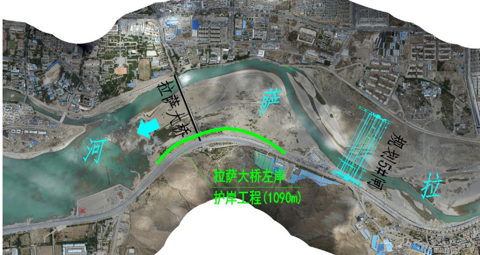
图 2.6-9 拉萨大桥左岸护岸工程平面布置示意图
